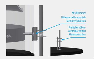
Die Umlufteinheit kann mittels Klemmverschlüssen in der Höhe um 340 mm verstellt werden.
